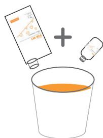
Mélanger la résine **Composant A** et le catalyseur **Composant B**
