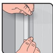
2. Plier la bande afin de former un angle et plaquer la bande armée sur la colle enduit joint plaque de plâtre avec le couteau à enduire (serrer la bande).
