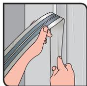
1. Appliquer une couche de colle enduit joint plaque de plâtre sur 30 à 40 mm de chaque côté de l'angle et positionner la bande armée.
