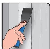
3. Recouvrir la bande armée de colle enduit joint plaque de plâtre en deux passes (charge et finition).
